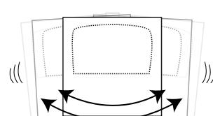
2. Agite el envase durante 1 ó 2 minutos antes del uso para asegurar que se mezcle adecuadamente; consulte la hoja de datos técnicos en cuanto a las recomendaciones específicas para la fórmula. Típicamente, la temperatura de la sustancia química debe estar entre 24 y 29°C (75 y 85°F).
