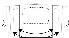
2. Agiter le kit pendant 1 à 2 minutes avant l'utilisation pour assurer un bon mélange, voir la FT pour les recommandations de mélange spécifiques à la formule. Le produit chimique doit normalement être à une température de 75 à 85°F (24 à 29°C).
