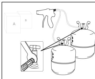
2. Conecte la manguera de código rojo al tanque del componente "A" y la manguera de código negro al tanque del componente "B", y apriete con una llave inglesa de 9/16".
